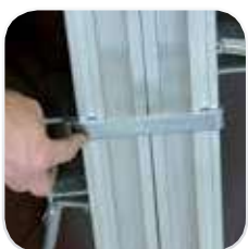
Mordassa d'unió ajustable per sistema de rosca
